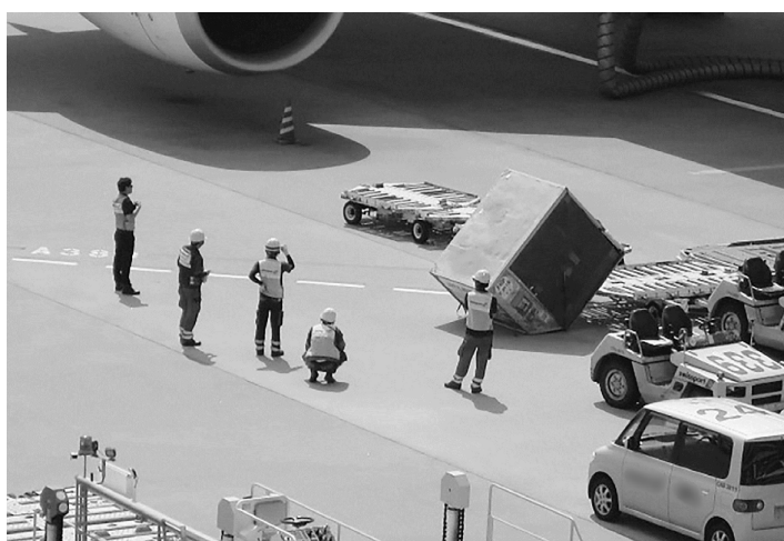
航空機からコンテナを取り降ろし作業中に起きた滑落事故
